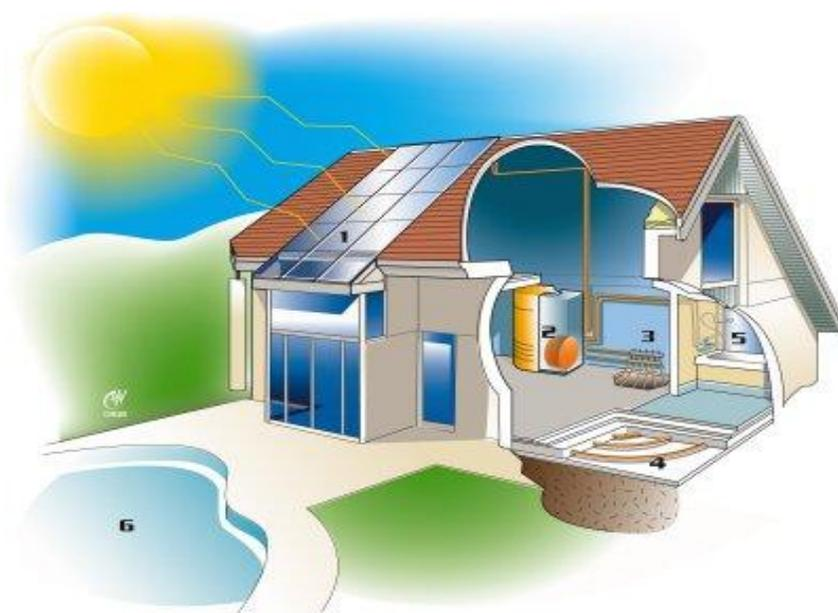
*La maison solaire de Clipsol équipée d'un Plancher Solaire Direct (PSD) © Clipsol*
